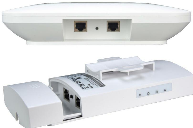
**POE WAN** – Porta RJ45 per collegare la rete filare principale (switch, router). Questa porta supporta alimentazione POE 48V e di norma va collegata a uno switch POE della rete. Se si collega questa porta a uno switch POE l'AP si accende, traendo alimentazione lungo il cavo di rete. Se si collega l'AP a uno switch senza alimentazione POE, come un router, occorre frapportare l'iniettore POE incluso.
